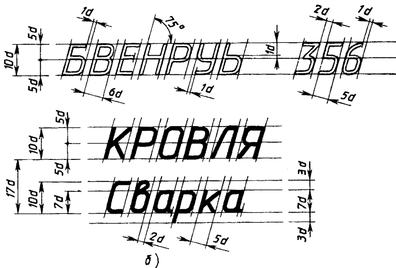
Рис. 9. Параметры шрифта (тип Б) (а) и приемы выполнения надписей (б)
